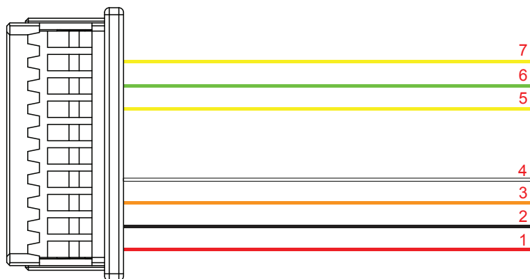
Morsettiera automotive con antivibrazione con lock antidistacco
