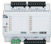
Modulo espansione 16 zone cablate. Collegamento diretto sul BUS della centrale. Fornito in contenitore standard DIN per una rapida e conveniente installazione con morsettiera estraibile per una manutenzione veloce. Dimensioni mm 106 x 104.
