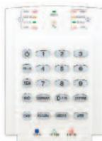
Tastiera con indicatori LED 10 zone e sportello verticale di protezione dei tasti, indicatori LED separati per la visualizzazione dello stato d'inserimento Totale, Notturno, Perimetrale e Disinserito di ciascuna delle 2 aree. Possibilità di regolazione della luminosità. Collegamento su BUS (max. 15 tastiere). 1 ingresso di zona.
