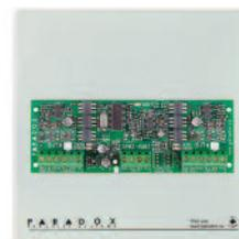
Modulo isolatore e amplificatore. Estende e divide il BUS di comunicazione in 2 uscite completamente isolate. Se una delle uscite è guasta o manomessa, l'altra continua a funzionare. 1 porta d'ingresso, 2 porte d'uscita completamente separate. Armadio metallico mm 200x255x76. Richiede alimentatore.
