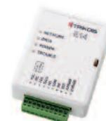
Comunicatore universale Ethernet. Legge i dati direttamente dal BUS dati delle centrali, i messaggi sono trasmessi con notifica push all'App PROTEGUS via cloud.
